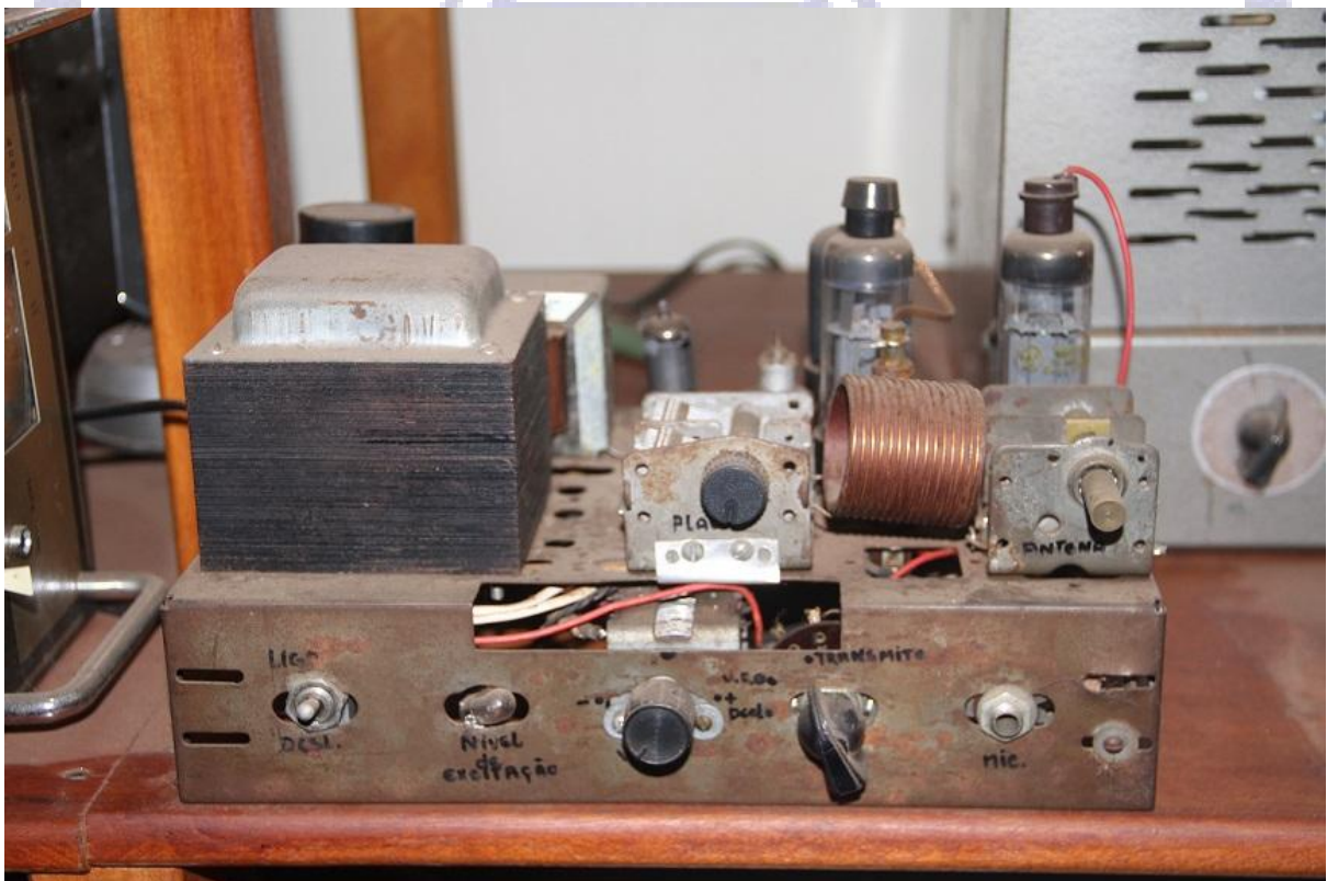
Imagem: Talvez um dos transmissores mais antigos do acervo montado no Brasil, é um Homebrew. Homebrew é uma gíria de radioamador para equipamento de rádio não comercial, construída em casa.
